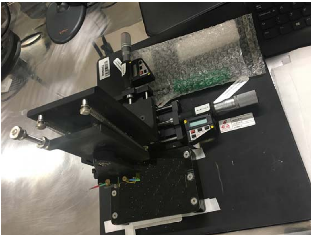
Figura 6 - Foto do Aparelho de TMA utilizado no nosso estudo. Modelo: MTA-I. Marca: Beecher Instruments .
