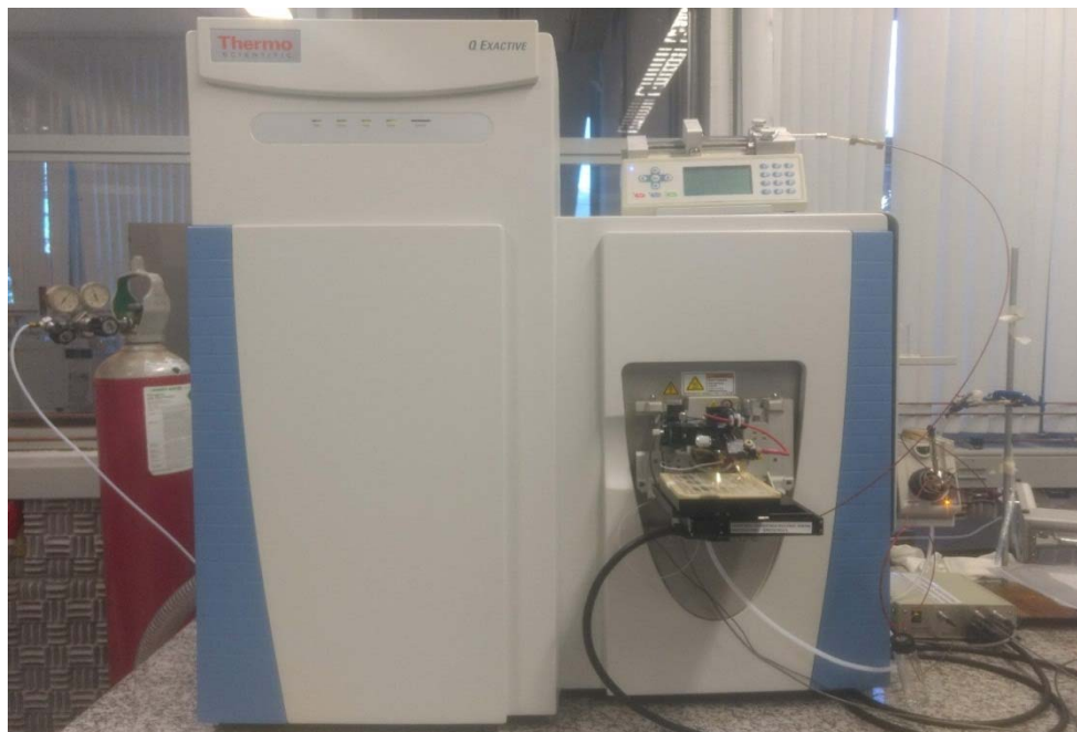
Figura 6 - Espectrômetro de massas (modelo Q Exactive) acoplado a uma plataforma móvel DESI (Omni Spray Ion Source 2-D modelo OS-3201).
