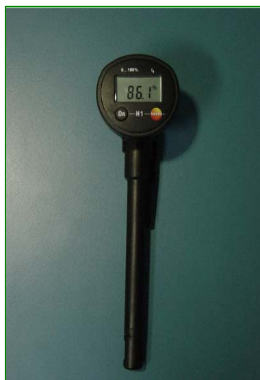
Figura 2 - Psicrômetro digital portátil modelo 605-H1 (Testo® - Alemanha)
