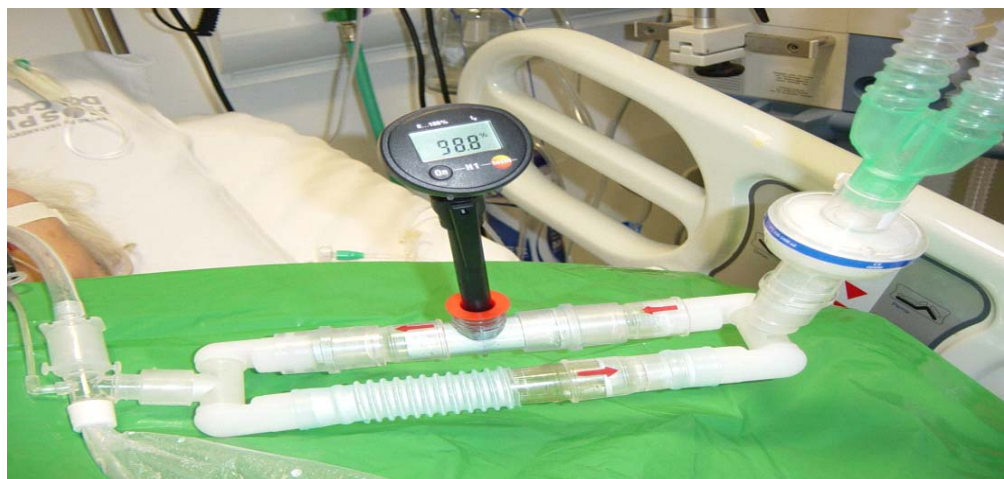
Figura 3 - Circuito intermediário com o psicrômetro acoplado e conectado ao paciente.
