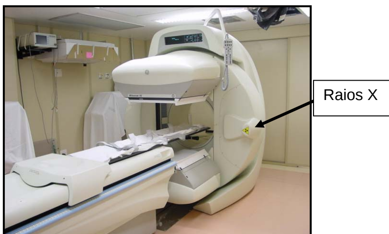
Figura 6 - Gama câmara SPECT com capacidade de adquirir imagem anatômica – Sistema Hawkeye (GE Healthcare).
