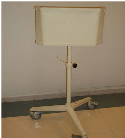
Figura 45 – Blindagem móvel com 15 mm de espessura de chumbo
