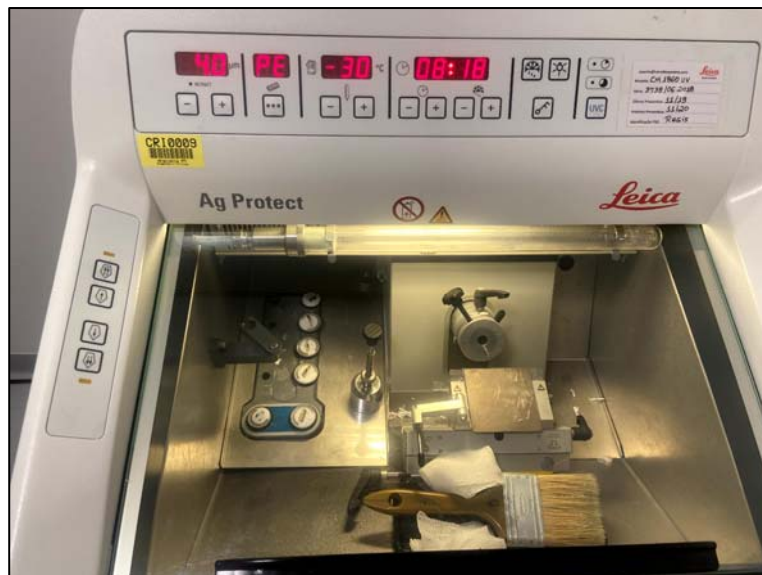
Figura 9 - Congelamento dos fragmentos a -30C em criótomo e realizado cortes de 4,0 micrometros.
