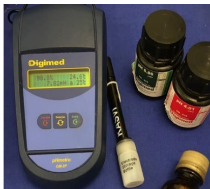
Figura 3 - Phmetro portátil 2D-DIGIMED + eletrodo de pH KASVI utilizado para aferir o pH salivar + soluções padrões de 6,86 e 4,01 para calibrar o aparelho.
