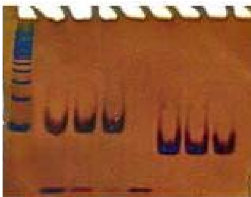
Figura 6 - Produto de PCR quantitativa fracionado em gel de acrilamida 8% obtido em reações com 400, 200 e 100 nM dos iniciadores dos genes INHBA e MCM2.
