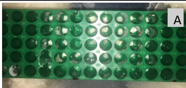
Figura 5 - Suporte para a irradiação das amostras e seu respectivo espelho. (A): Dispositivo com as amostras imersas em água prontas para irradiação.
