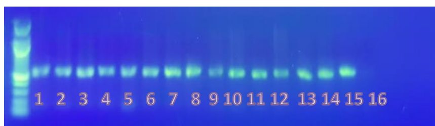
Figura 6 -Análise de amplificação das regiões V3 e V4 do rRNA 16S em gel de agarose 1% de amostras de pacientes do Amazonas e de São Paulo. Legenda: 1- 27A 2- 30A 3- 37A 4- 41A 5- 43A 6- 46A 7- PA45T 8- PA54T 9- PA56T 10- PA60T 11- PA65N 12- PA55N 13- 52A 14- 63A 15- Controle positivo ( E.coli ) 16 – Controle negativo (sem DNA).
